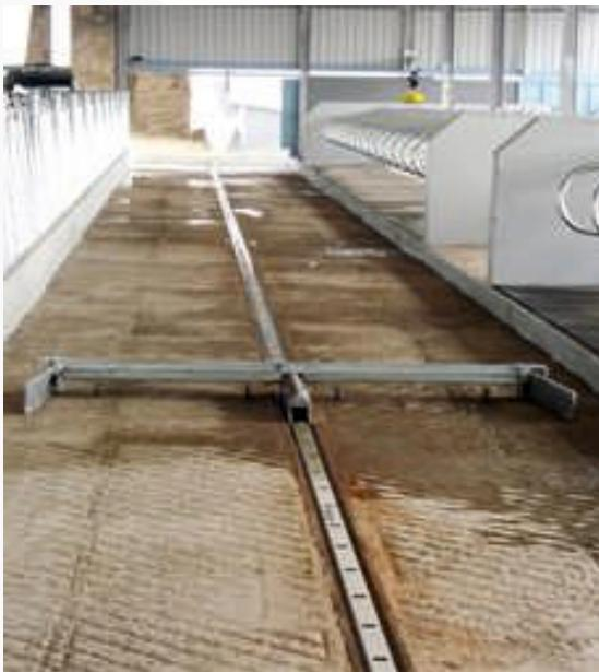
Hayvan dostu bir dizayn ile dayanıklı olarak üretilmiş diamak hidrolik gübre sıyrıcı ve uzun saman parçaları içeren katı gübreyi ve sıvı gübreyi idare edebilir. Kayan bıçaklar ve yan kanatlar en uygun hayvan hijyenii için mükemmel temizleme sağlar. Ağır işe dayanıklı, adım mekanizmali merkezi gövde çalışmanın güvenli olmasını sağlar.
