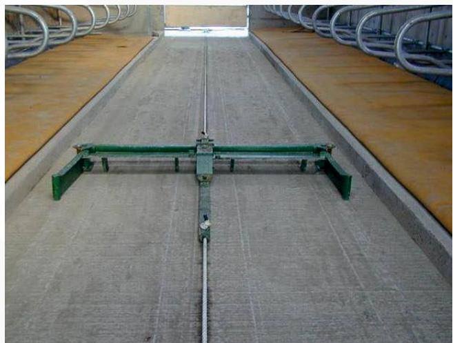
Ahır zeminini en iyi şekilde temizler hayvan refahını ve hayvan ayak sağlığını önemli ölçüde etkiler böylece daha sağlıklı bir sürüye sahip olmanızı sağlar, kurulumu kolaydır, hareketli yan kanatları sayesinde gübre kanalınıza kolaylıkla uyum sağlar, güvenilir ve sağlam yapıdadır. Sıyrıcılarda kullanılan çelik konstrüksiyon aksam sıcak daldırma galvanizle kaplıdır.
