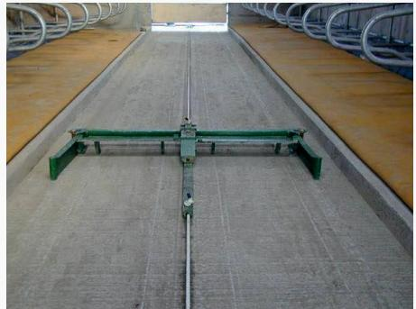
Ahir zeminini en iyi şekilde temizler hayvan ferahı ve hayvan ayak sağlığını önemli ölçüde etkiler böylece daha sağlıklı bir sürüye sahip olmanızı sağlar, kurulumu kolaydır, hareketli yan kanatları sayesinde gübre kanalınıza kolaylıkla uyum sağlar, güvenilir ve sağlam yapıdadır.
