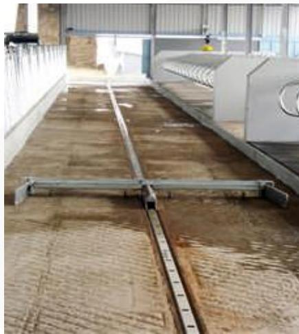
Hayvan dostu bir dizayn ile dayanıklı olarak üretilmiş DİAMAK hidrolik gübre sıyrıcı ve uzun saman parçaları içeren katı gübreyi ve sıvı gübreyi idare edebilir. Kayan bıçaklar ve yan kanatlar en uygun hayvan hijyenî için mükemmel temizleme sağlar. Ağır işe dayanıklı, adım mekanizmalı merkezi gövde çalışmanın güvenli olmasını sağlar.
